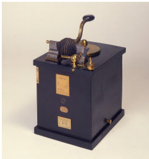
Fig. 8: Magneto-electric hydrogen lighter with Nobili's sparking magnet. (Liceo Classico N.Machiavelli, Lucca)
